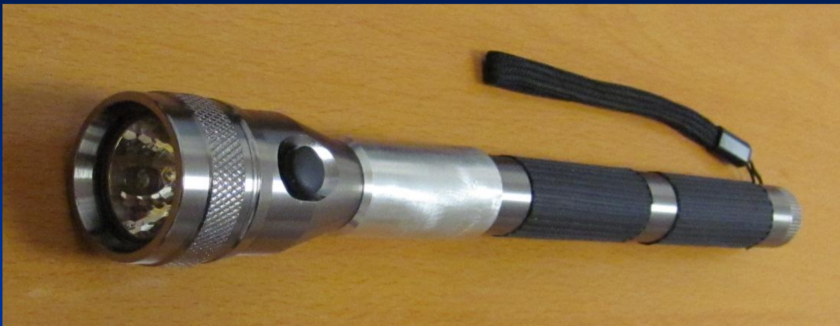
Svítilna SR11 s přidaným nastavcem pro čtvrtý článek.
